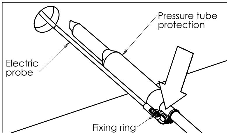
FISSAGGIO TUBO AL SONDINO: Utilizzando del nastro isolante fissare l'estremità del tubo al sondino. A questo punto è possibile recuperare il sondino.
