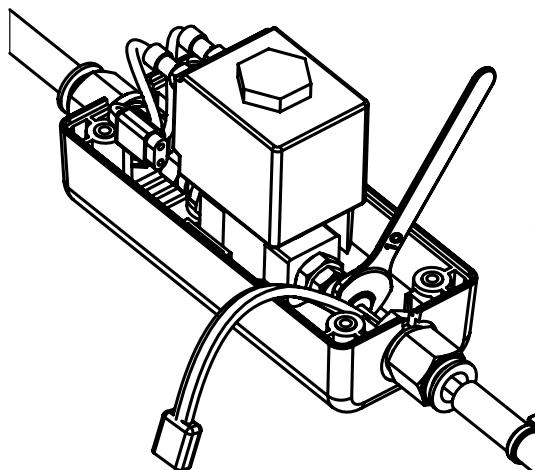
Serrare, con moderazione, il connettore di portata gas con la chiave da 10mm.
