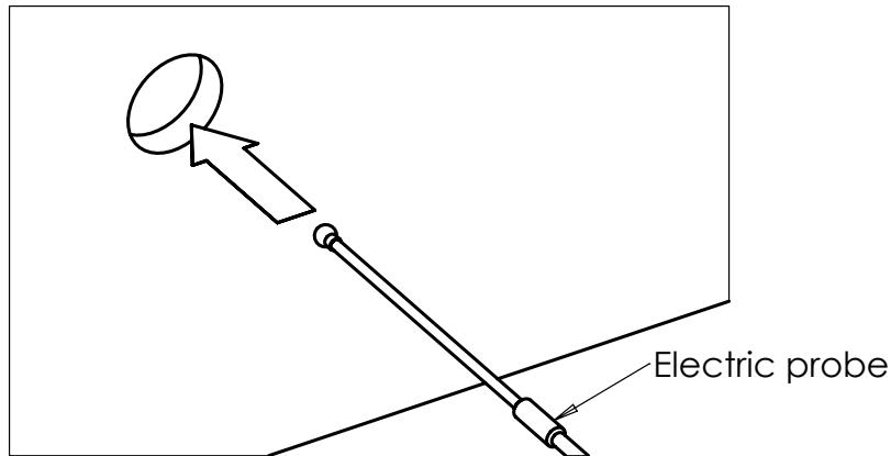
FISSAGGIO TUBO AL SONDINO: Utilizzando una fascetta in plastica agganciare l'apposito occhiello all'estremità del sondino.
